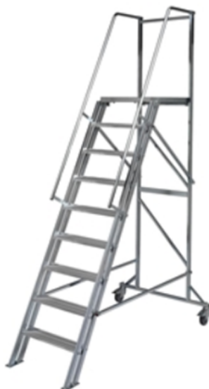
Figur 3 Stige med rekkverk UTEN fallsikring. Krav til fallsikring hvis stiger er over 2 meter.
