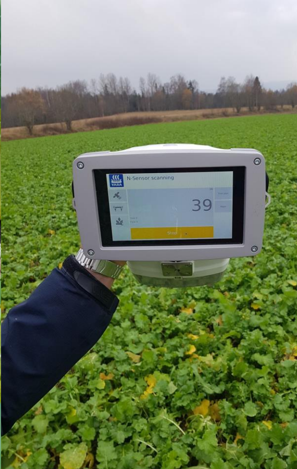
29. Oktober – høstryps – måling med håndholdt N-Sensor
