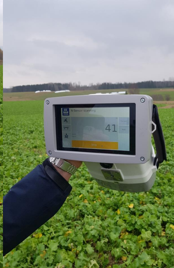
29. Oktober – høstryps – måling med håndholdt N-Sensor
