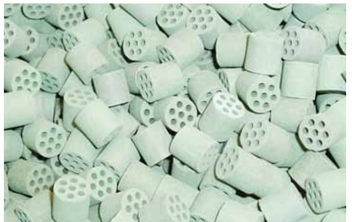
FIGUR 5: Katalysatorpellets. Ny renseteknologi utviklet av Yara reduserer \text{N}_2\text{O} utslippene ved produksjonen med opptil 90 %.
